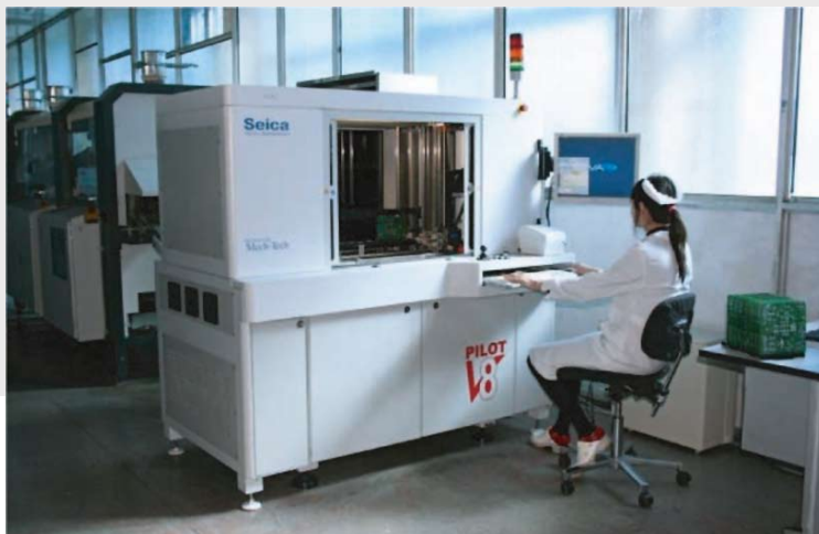
Fig. 1: il sistema di collaudo a sonde mobili Pilot V8 di Seica
