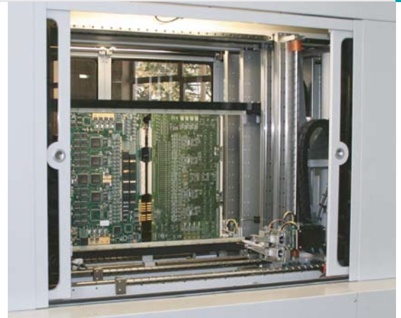
Fig. 2 - Il collaudo simultaneo di 2 UUT su ATE Pilot V8 di Seica
