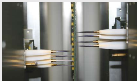
Particolare delle otto sonde mobili del sistema Pilot V8
