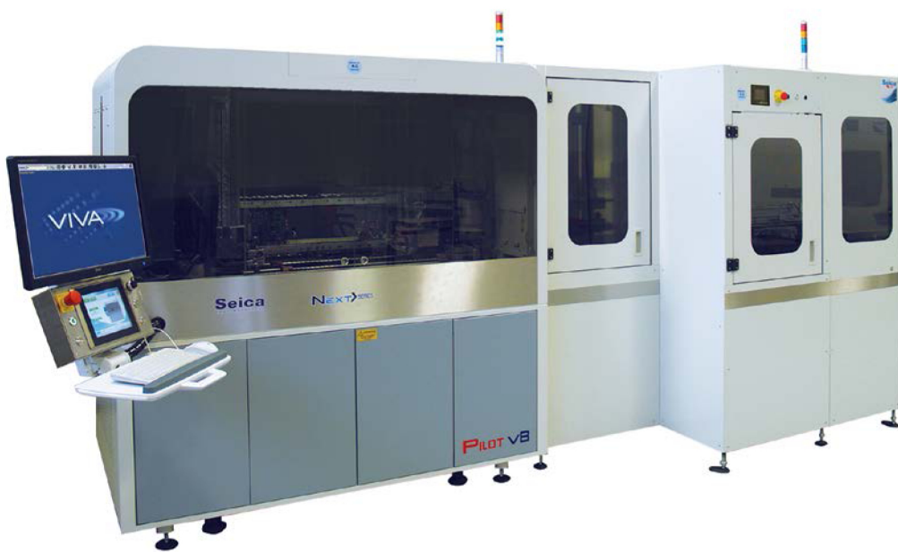
Fig.4 - Pilot V8 Next, il sistema a sonde mobili automatico di SEICA per il test dei PCB; verticale dual side con 8 sonde (4 per lato) e configurabile con 20 diverse risorse mobili disponibili
